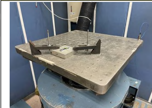
17. Non-Operating Vibration Test (Z axis)
